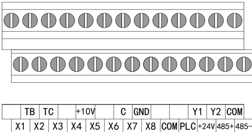
图 3-24 控制电路端子 1
